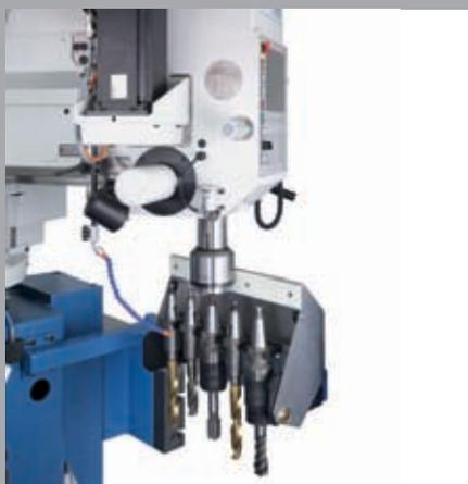
Werkzeugwechseleinrichtung P. 8.10 an der rechten Maschinenseite zur Aufnahme von 5 Werkzeugen
