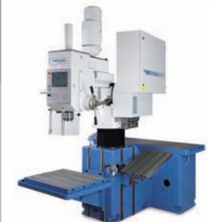
Winkeltisch P. 2.30 auf der Maschinenrückseite mit Schwenktisch P. 2.40 seitlich
